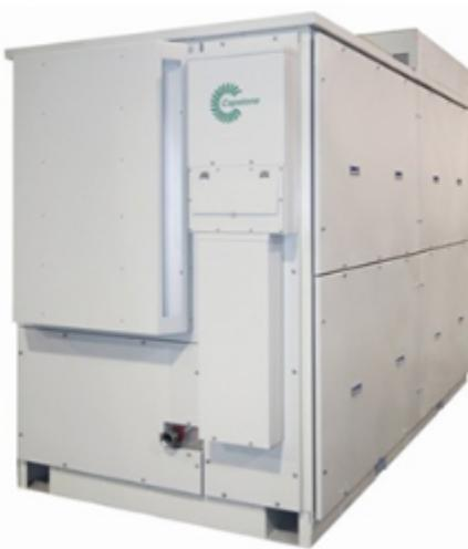
微型燃气轮机在运行过程中具有以下特点：①质量轻，使用方便。②操作灵活，不但可以运行，还可以与电网并联运行，且2种方式之间可以自动切换。③运行十分安全。④清洁，排放少。⑤振动小，噪声低，低于65分贝 $10m$ 。⑥燃料种类多，消耗少、成本低。适用于沼气、天然气、石油、汽油、丙烷、煤层气、煤油、酒精等各种气体和液体燃料。⑦运行时间长。微型燃气轮机系统可连续运行4000h，整体调整间隔时间为11000h，设计寿命45000h。⑧可分布式。⑨不需要润滑。⑩可使用空气轴。⑪可以集成扩大容量，灵活配置微型燃气轮机。⑫维护成本很低，可以在远处进行控制和诊断。因为没有润滑系统，且应用独特的空气轴承技术，微型燃气轮机维修成本极低，只需要更换空气过滤网就行。⑬燃料转换效率高。微燃机的基本技术特征是采用径流式叶轮机械（向心式透平和离心式压气机）以及回热循环。江苏双循环燃气轮机
